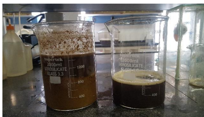
شکل (۱) سمت راست: نمونه فاضلاب بعد از انجام جار تست؛ سمت چپ: نمونه فاضلاب خام
