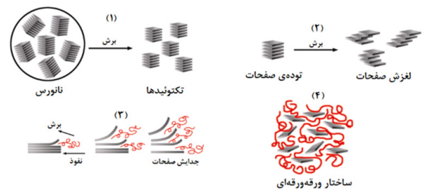
شکل ۳ طرح‌واره‌ی مراحل تهیه‌ی نانوکامپوزیت توسط فرایند اختلاط
