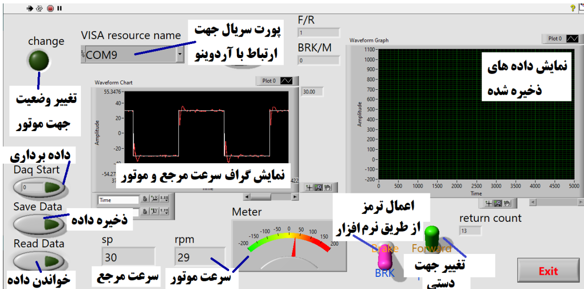
شکل ۷: صفحه طراحی شده در نرم افزار Labview برای سیستم آزمایشگاهی کنترل سرعت دینامیکی موتور BLDC.
